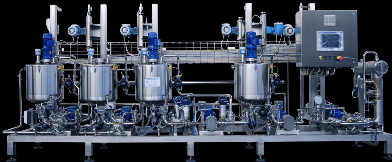
Il sistema di dosaggio "D Series" permette l'iniezione misurata di microelementi nel prodotto finito come acido citrico, taurina, colori e aromi.
